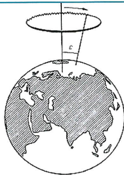
Influence de la précession et de la nutation sur la direction de l'axe de rotation de la Terre. Fig. 18
